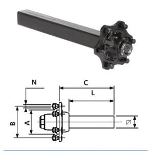
Laufachsstummel 2000/2500/1750 kg bei 40 km/h 230/290 mm lang, Achskörper 60 mm VKT 6/160/205/M18 x 1.5, für Bodenbearbeitung Typ "I R"
