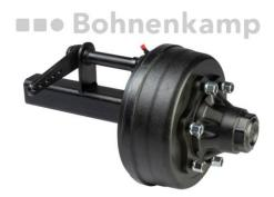
Bremsachsstummel 3250/3750/3000 kg bei 40 km/h 351/500 mm lang, Achskörper 70 mm VKT 6/161/205/M18x1.5, 300x90, 309E
